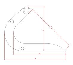
A : Ouverture du godet B : Profondeur C : Hauteur D : Encombrement
